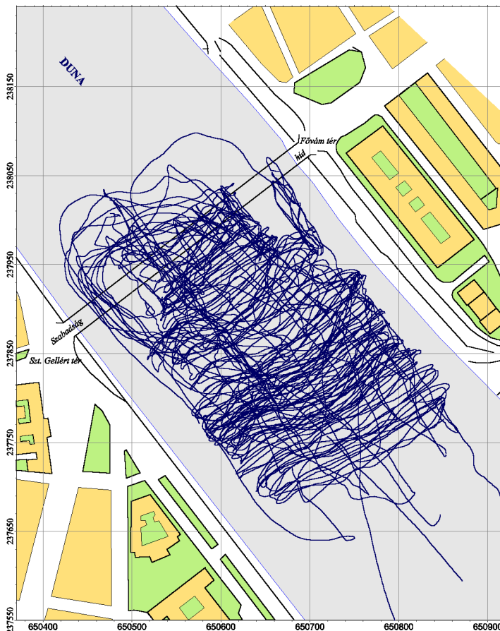
5.1. ábra: A Duna Szabadság híd alatti szakaszán végzett egycsatornás ultra-nagy felbontású szeizmikus szelvényezés helyszínrajza. A terület kereszt-, és folyásirányú szelvények együttes hálózatával került felmérésre.
