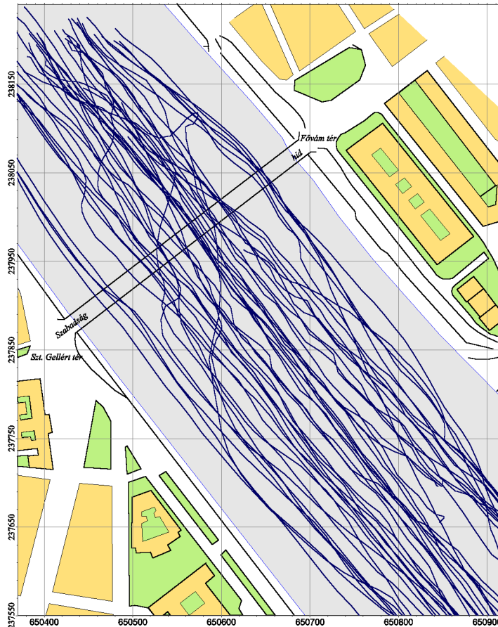
5.4. ábra: A többcsatornás mérés egyes szelvényeihez tartozó forrásponatok nyomvonala. A mérés során összesen 46 vonalpár került felmérésre. Az egyes csatornák minden egyes lövéshez tartozó forrás és észlelésponati koordinátájának számítása után a szeizmikus adatrendszert az 5.8. ábrán látható szabályos hálózatba rendeztük át. A további feldolgozás ebben a koordináta rendszerben történt.
