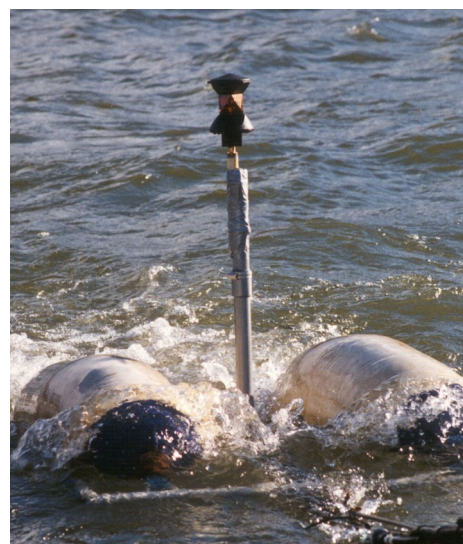
5.6. ábra: A többcsatornás mérés pozicionálásához használt eszközök a hajó mögött. A két kinagyított részlet a hidrofonkábel végén elhelyezett GeoExplorer II-es GPS berendezést (felső kép), illetve a forrás felett rögzített prizmát (alsó kép) mutatja.
