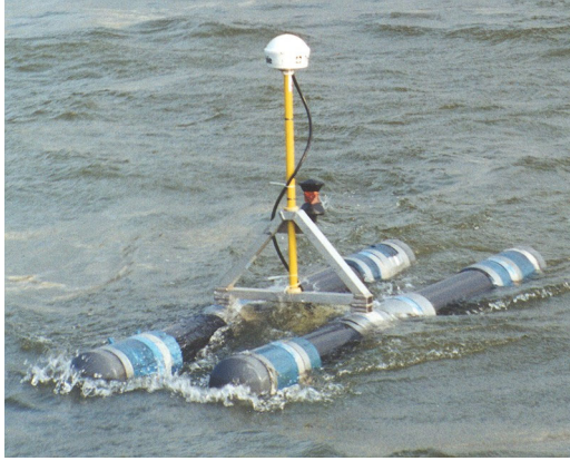
5.2. ábra: A mérés során alkalmazott pozicionálás DGPS és automatikus követésű lézeres teodolit kombinálásával történt. A képen a GPS antenna és a lézeres teodolit 360°-os prizmája látható egymás felett, a mérőműszer geometriai középpontjában.
